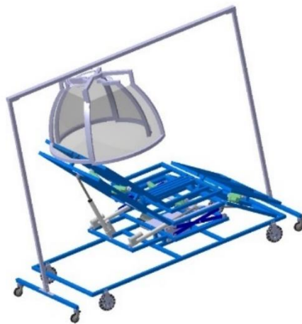
Fig. 1 Sub-sistemul cupolă al patului inteligent – proiectare și fabricare componente
